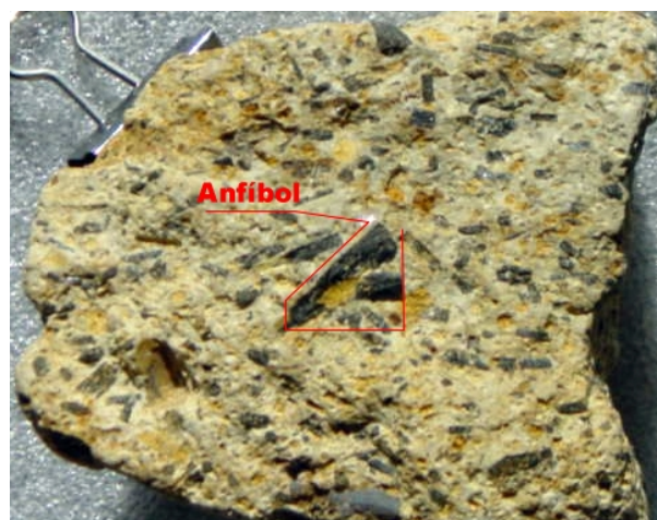
Foto 3. Andesita: roca volcánica de grano fino compuesta por plagioclasa, ortopiroxeno y hornblenda.
