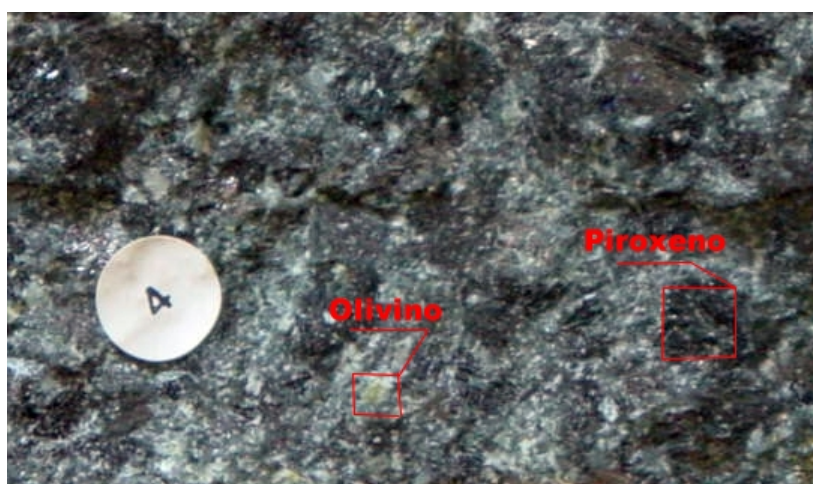
Foto 4. Gabbro: roca ígnea básica de grano grueso compuesta por plagioclasa rica en calcio (Ca), ortopiroxeno y clinopiroxeno.
