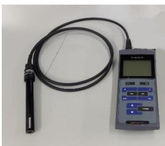
**Figura 3.1. Conductímetro**
