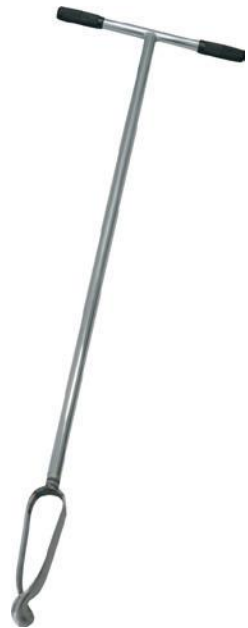
Figura 4. Barreno tipo Edelman.
